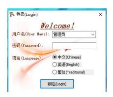
设备出厂默认 IP 地址是 192.168.1.200, 控制计算机 ip 地址需是同一网段, 选择 NET 连接, 输入 ip 地址, 点击**链接即可** 若用 RS232 串口连接, 默认波特率为 115200。
