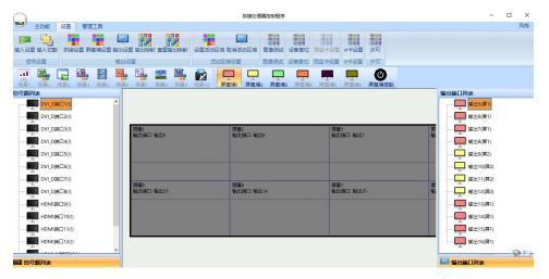
点击软件右侧输出端口列表,选择想要的输出通道将其拖动到中间虚拟大屏中相应的屏幕上
